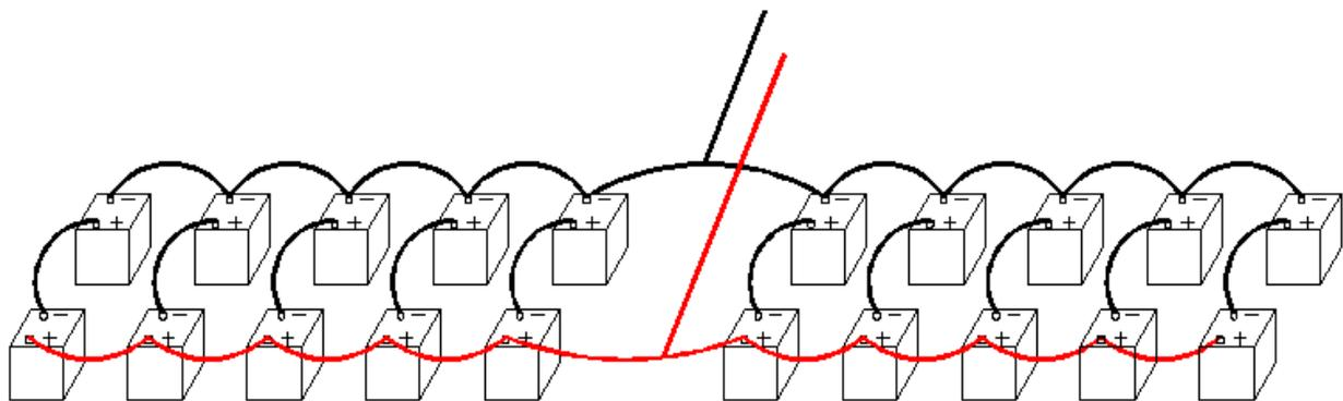
12V BATTERIES WIRED FOR 24V
