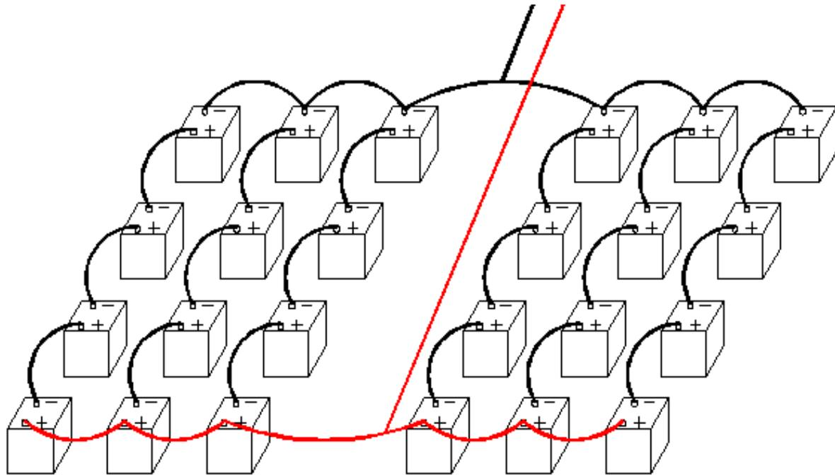
6V BATTERIES WIRED FOR 24V
