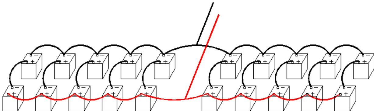
12V BATTERIES WIRED FOR 24V
