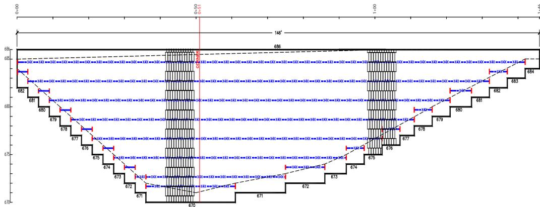
FRONT ELEVATION - RETAINING WALL - STA 0+00 to 1+46
