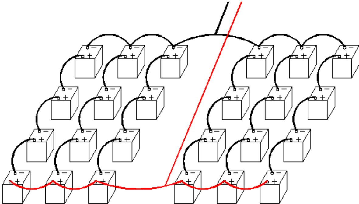
6V BATTERIES WIRED FOR 24V
