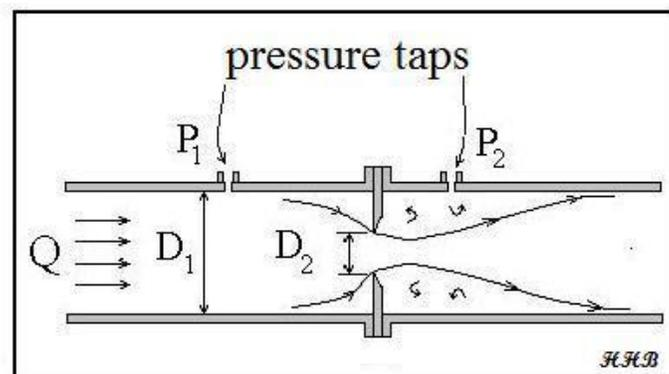
Orifice Meter Parameters
