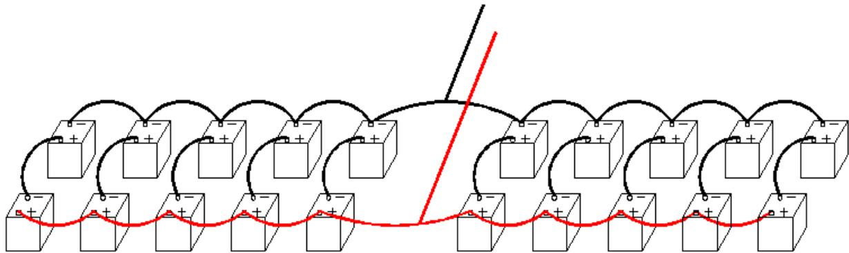
12V BATTERIES WIRED FOR 24V
