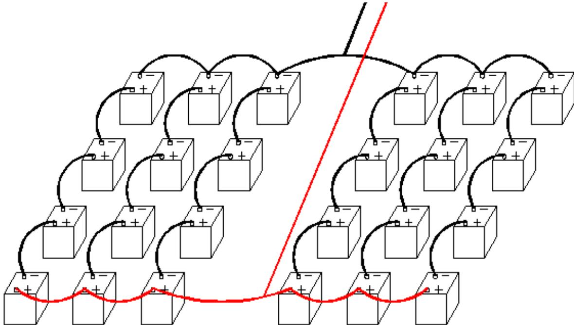
6V BATTERIES WIRED FOR 24V
