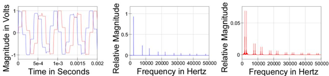
Figure 12.0  $V_6$  &  $V_8$  Quadrature pair,  $V_6$  &  $V_8$  Spectra, and  $V_7$  &  $V_{10}$  Burst Spectra
