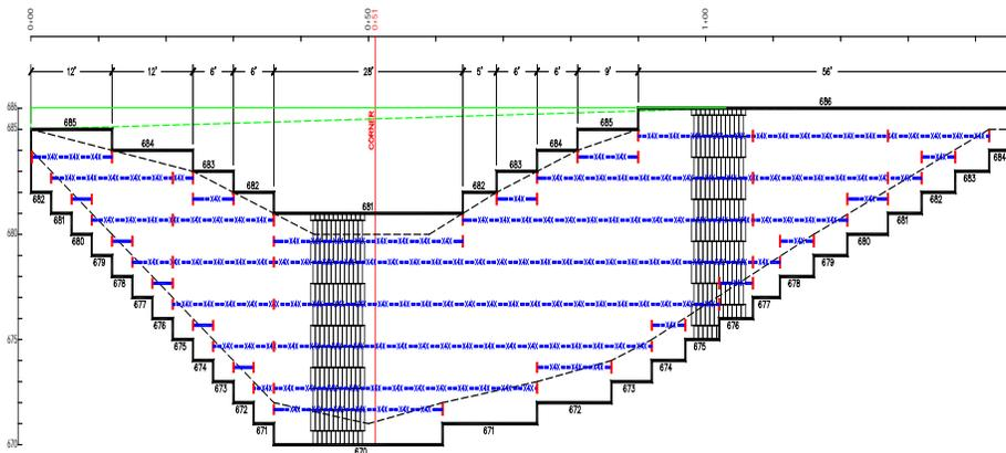
FRONT ELEVATION - RETAINING WALL - STA 0+00 to 1+46
